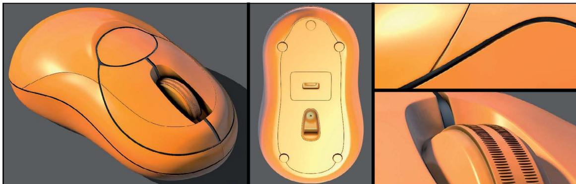
**Figura 9.136** La presenza di facce interne sulla linea di ribaltamento, genera col Mirror degli artefatti legati al non-manifold.
